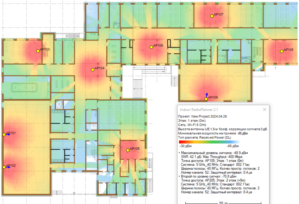
Пример расчета тепловой карты для indoor сети Wi-Fi
