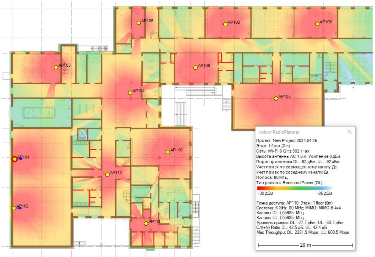
Пример расчета уровней принимаемой мощности для indoor сети Wi-Fi
